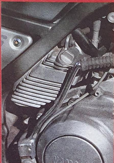
▲ Notez le petit réservoir aileté en aluminium. De quoi se passer d'un radiateur d'huile et gagner encore du poids !
