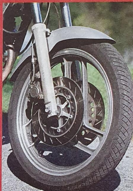
▲ Le freinage est assuré par deux disques avant de 267 mm de diamètre équipés d'étriers à pistons opposés.
