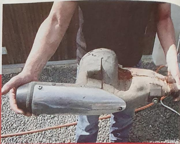
▲ Très particulier l'échappement de la SRX ! Les deux tubes en acier inoxydable se rejoignent dans un unique silencieux très court, dont les chambres de tranquillisation régulent la sonorité et optimisent la puissance et l'écoulement des gaz.
